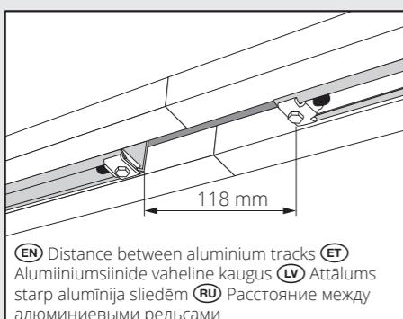
**(EN)** Distance between aluminium tracks **(ET)** Alumiiniumiide vaheline kaugus **(LV)** Attālums starp alumīnija sliedēm **(RU)** Расстояние между алюминиевыми рельсами
